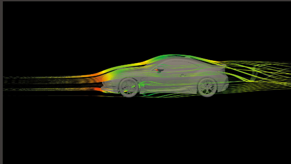
CFD解析からのフィードバックを取り入れ、パーツデザインを行っています。
