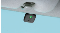
GPS内蔵ETCアンテナ装着例
