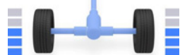
ディスプレイオーディオ内の前後輪トルク配分量表示
