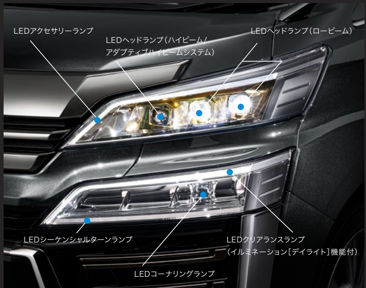
LEDアクセサリランプ LEDヘッドランプ(ハイビーム/アダプティブハイビームシステム) LEDヘッドランプ(ロービーム) LEDシーケンシャルターンランプ LEDクリアランスランプ(イルミネーション[デイルイト]機能付) LEDコーナリングランプ ■3眼LEDヘッドランプ(ハイ・ロービーム/オートレベリング機能付)+LEDクリアランスランプ(イルミネーション[デイルイト]機能付)+LEDアクセサリランプ ■LEDコーナリングランプ
