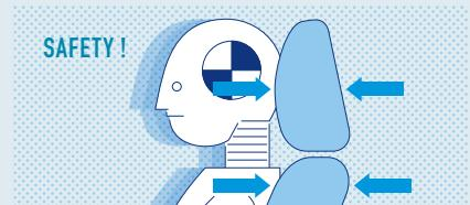
後方から衝突された際に、背中がシートに沈み込み、頭と背中を同時に支えて頸部への衝撃を緩和する構造をもったWILコンセプトシートを採用しています。
