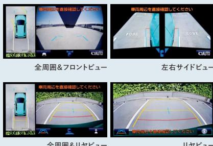
車両の前後左右に搭載した4つのカメラから取り込んだ映像を合成して、クルマを真上から見ているような映像を表示。駐車時の安全確認をしっかりとサポートします。
