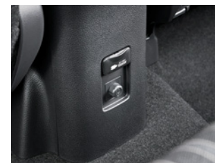
㊿ アクセサリーコンセント(AC100V・ 1500W/1個/非常時給電システム付)
