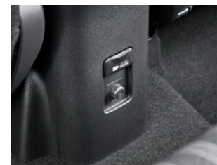
㊿ アクセサリーコンセント(AC100V・ 1500W/1個/非常時給電システム付)
