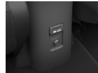
⑥アクセサリコンセント (AC100V・ 1500W/1個/非常時給電システム付)
