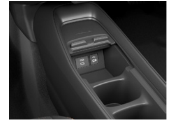
③充電用USB端子 (Type-C) / USB入力 (動画・音楽再生/給電 [Type-C]) [Zに標準装備。USB入力 (動画・音楽再生/ 給電 [Type-C]) は全車に標準装備]
