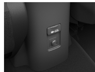
㉛ アクセサリーコンセント (AC100V・ 1500W/1個/非常時給電システム付)
