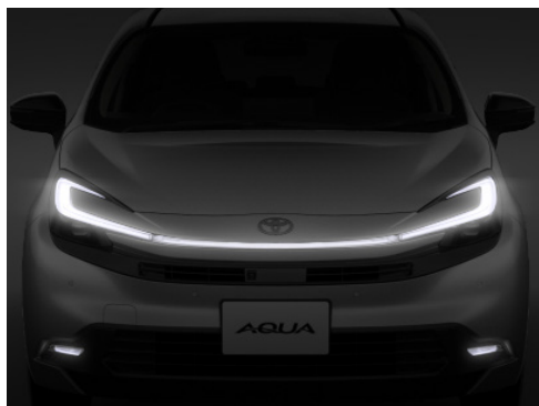
LEDクリアランスランプ&amp;LEDアクセサリランプ点灯 ■写真はZ(2WD)。
