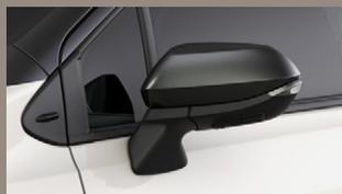
▶ LEDサイドターンランプ付オート電動格納式リモコンカラードドアミラー (ヒーター付/ルーフカラー共通色)
