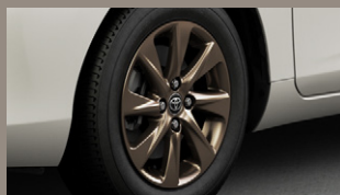
▶ 185/65R15タイヤ&15×6Jアルミホイール (ブロンズ/センターオーナメント付) [E-Four]
