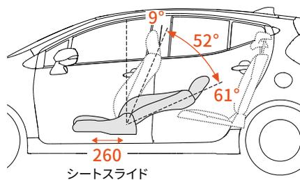
\*1.フロントドアの開口角度は60°(標準車と同じ)です。 \*2.足元スペースは中間ロック位置でのドア内張りまでの寸法です。 \*3.シートの座面高は、チルト時の座面中央最高部までの寸法です。
