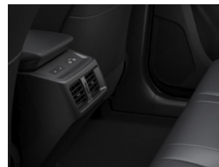
⑫充電用USB端子 (Type-C・2口合計60W) / 2個 ■USB PD (USB Power Delivery) に対応しています。
