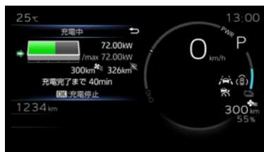
充電中のIG-ON状態
