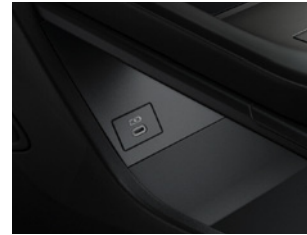
④助手席側：充電用USB端子 (Type-C) / 1個 運転席側：通信/充電用USB端子 (Type-C) / 1個&アクセサリソケット (DC12V・120W/1個) ■写真は助手席側です。
