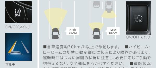
■自車速度約30km/h以上で作動します。 ■ハイビーム・ロービームの切替自動制御には状況により限界があります。運転時にはつねに周囲の状況に注意し、必要に応じて手動で切替えるなど、安全運転を心がけてください。 ■道路状況および天候状態等によっては、ご利用になれない場合があります。詳しくは取扱書をご覧ください。
