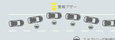
■本システムは幅約3m以上の車線を自車速度約50km/h以上で走行時に作動します。また道路状況、車両状態および天候状態等によっては、ご使用になれない場合があります。詳しくは取扱書をご覧ください。 ■レーンディバーチャーラートはあくまで運転補助機能です。本機能を過信せず、必ずドライバーが責任を持って運転してください。
