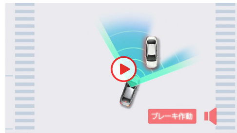
[自車右折時、直進してくる対向車や対向自動二輪車を検知。]
