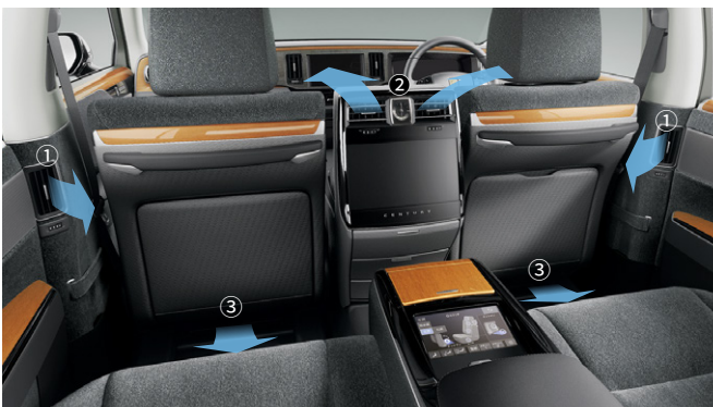
後席エアコン吹き出し口 ①センターピラー ②タワーコンソール ③フロア
