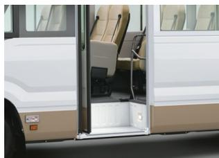
折戸ドア専用 3 段式ドアステップ
