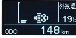
排出ガス浄化装置堆積モニター
