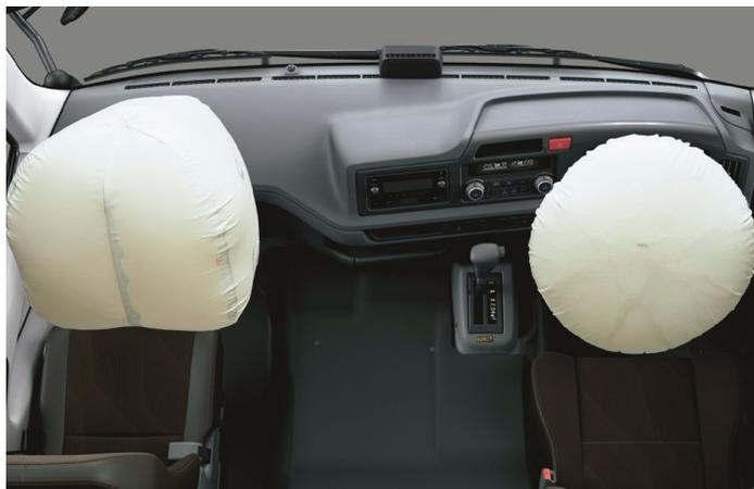
※ SRS [乗員保護補助装置] : Supplemental Restraint System
