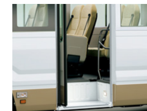
▶センタードア(折戸ドア・オート) (開閉予告ブザー・挟み込み防止機能付) LX(24人乗り・27人乗りパッケージ・25人乗り)
