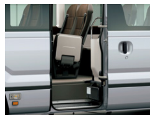
▶センタードア(グライドドア・オート) (開閉予告ブザー・挟み込み防止機能&イージークローザー付) GX(25人乗り) LX
