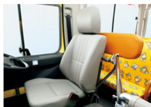
▶運転席リクライニング&スライド機構 ▶ヘッドレスト表皮(ビニールレザー)
