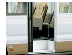
▶センタードア(折戸ドア・オート) (開閉予告ブザー・挟み込み防止機能付) LX(24人乗り・27人乗りパッケージ・25人乗り)
