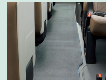
③ 通路カーペット(カットパイル)
