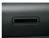
リヤヒーターダクト
