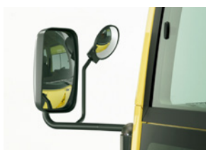
▶助手席リモコンワイドビューミラー (電動格納式・熱線ヒーター付)
