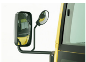
▶助手席リモコンワイドビューミラー (電動格納式・熱線ヒーター付)
