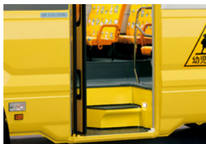
▶センタードア(折戸ドア・手動) ▶折戸ドア専用3段式ドアステップ(幼児用)
