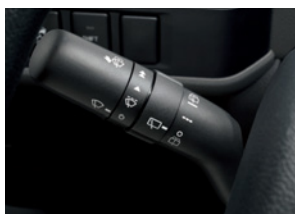
▶間欠式フロントウインドウワイパー 写真はリヤワイパー装着車
