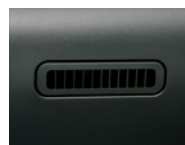
リヤヒーターダクト
