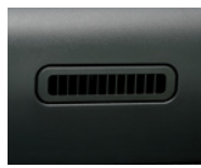
リヤヒーターダクト
