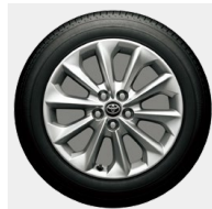
205/55R16タイヤ&16x7Jアルミホイール(センターオーナメント付)
