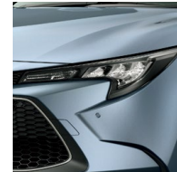
3灯式LEDヘッドランプ+LEDターンランプ+LEDクリアランスランプ
