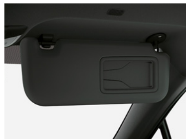
▲サンバイザー(バニティミラー[運転席・助手席]/チケットホルダー[運転席・助手席]付)
