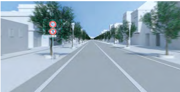
カメラで道路標識を認識しマルチインフォメーションディスプレイに表示。
