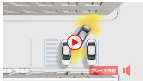
パーキングサポートブレーキ(周辺静止物)
