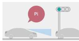
■オートマチック車は、[P]・[R]以外のシフトポジションでブレーキペダルを踏んで停止している時に作動します。[N]の時はブレーキペダルを踏んでいなくても作動します。マニュアル車は、[R]以外でブレーキペダルを踏んでいる時に作動します。■先行車が約4m以上進んでも自車が止まったままだとシステムが判断した場合に作動します。なお、機能のON/OFFおよび告知タイミングの変更が可能です。詳しくは取扱書をご覧ください。■先行車発進告知機能は、Toyota Safety Senseのセンサー技術を活用したその他の機能です。
