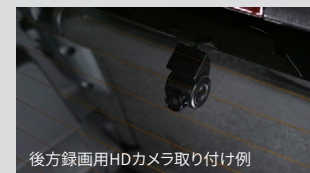
後方録画用HDカメラ取り付け例
