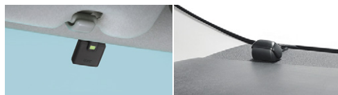
ETCアンテナ装着例
