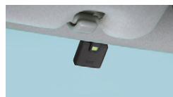
ETCアンテナ装着例
