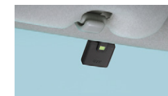
ETCアンテナ装着例
