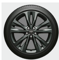
215/45R17タイヤ&17x7Jアルミホイール (ダークグレーメタリック塗装/センターオーナメント付)
