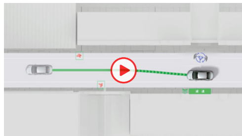
歩行者/自転車運転者/駐車車両に対する支援 [減速・操舵制御]
