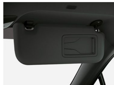
④サンバイザー (バニティミラー [運転席・助手席] / チケットホルダー [運転席・助手席] 付)
