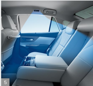
後席専用の空調システム。 リヤオートエアコン(クーラー機能付)
