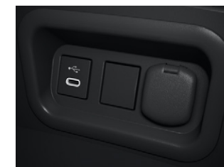
Ⓔ 通信/充電用USB端子 (Type-C/センターコンソールボックス内側1個) Ⓖ アクセサリーソケット (DC12V・120W/センターコンソールボックス内側1個)
