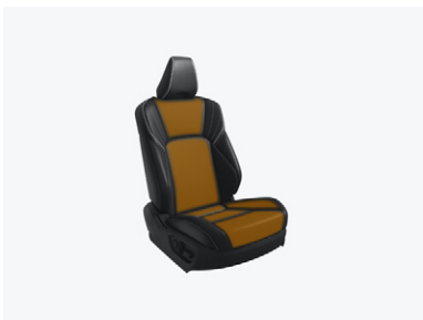
オレンジは、ヒーター加温箇所
