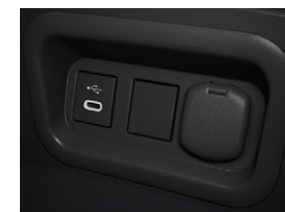
⑧通信/充電用USB端子 (Type-C/センターコンソールボックス内側1個) ⑧アクセサリソケット (DC12V・120W/センターコンソールボックス内側1個)
