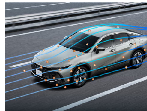
除電スタビライジングプラスシートありのイメージ: 走行によるタイヤ周りの帯電を低減することで、タイヤ周りの流れの乱れを低減
