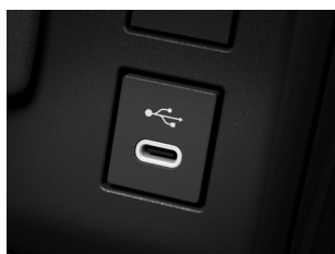
㊱通信/充電用USB端子 (Type-C/センターコンソールボックス内側1個) [CROSSOVER RS、CROSSOVER Z、CROSSOVER Gに標準装備。CROSSOVER Xにメーカーオプション]
