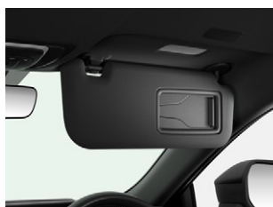
㉜サンバイザー (バニティミラー・LED天井照明・チケットホルダー付)
