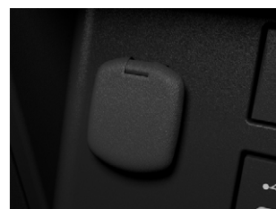
㊲アクセサリソケット (DC12V/120W/センターコンソールボックス内側1個)
