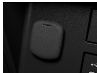
㊲アクセサリソケット(DC12V・120W/センターコンソール後部内側1個)
