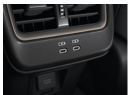
②充電用USB端子 (Type-C/センターコンソール後部2個・LED照明付)
