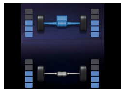
マルチインフォメーションディスプレイ内の前後輪トルク配分量表示
