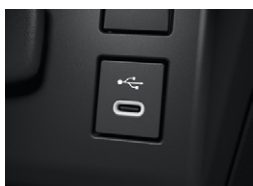
⑧通信/充電用USB端子 (Type-C/センターコンソールボックス内側1個)
