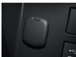
㉞アクセサリソケット (DC12V・120W/センターコンソールボックス内側1個)
