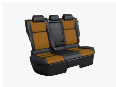
オレンジは、ヒーター加温箇所
