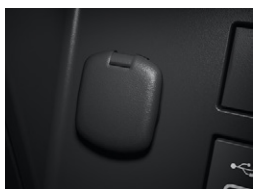
②アクセサリソケット (DC12V・120W/センターコンソールボックス内側1個)
