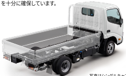
写真はシングルキャブ・2WD・フルジャストロー・木製デッキ・1.6トン積・2.8Lディーゼル車。ボディカラーはホワイト<058>。■写真は合成です。
