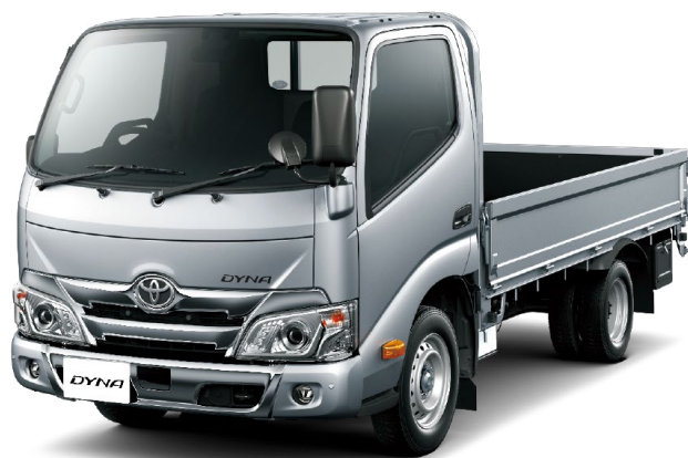
写真はシングルキャブ・2WD・ジャストロー・木製デッキ・1.55トン積・2.8Lディーゼル車。“Gパッケージ”装着車。 ボディカラーのシルバーメタリック<199>はメーカーオプション。車種番号4
