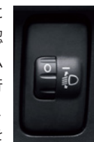
ヘッドランプ レベリングスイッチ (マニュアル)
