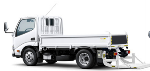
リフト付トラック (スイング式) 〈極東開発工業〉 〈新明和工業〉
