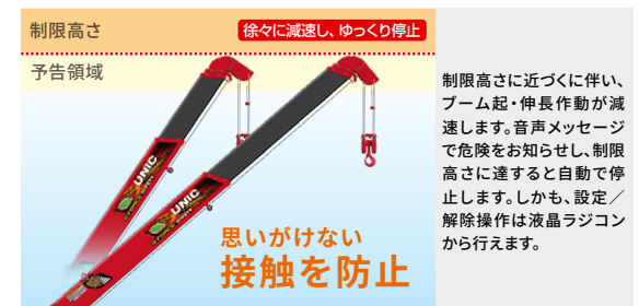
●高さ制限装置
