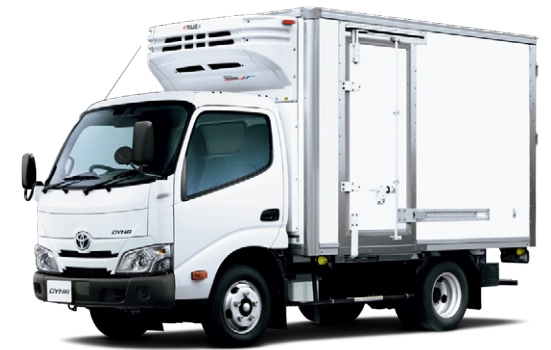
車型番号 H5 Photo:パッケージ型中温冷凍車 標準キャブ・標準ボディ・フルジャストロー (2KG-XZU605-WBBTXG) ※スライドアーム式サイドドア、ラッシングレールは架装オプション。
