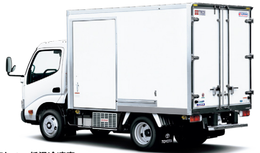
車型番号 F3 Photo:低温冷凍車 標準キャブ・標準ボディ・フルジャストロー (2KG-XZC605-VTBFZG) ※ステンレスパッケージ、ワンタッチスライド式左サイドドア(ドア枠ステンレスタイプ)、サイドステップ、D型バンパーゴムは架装オプション。
