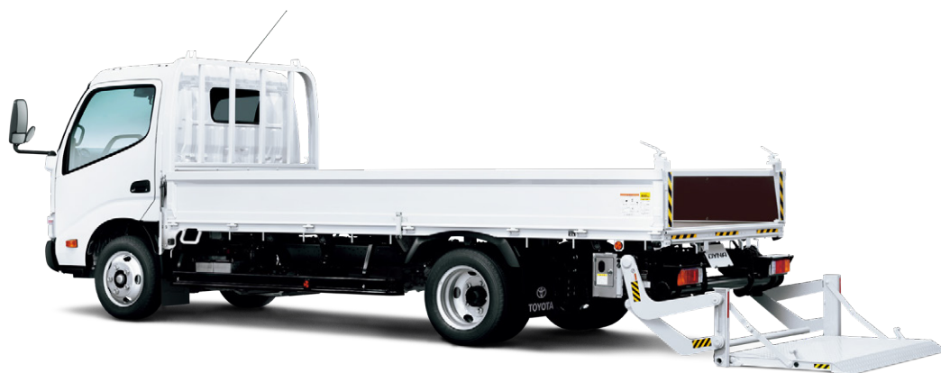
車型番号 K7 Photo:パワーゲート車 リフト能力800kg・2.0トン積・標準キャブ・ロングデッキ・フルジャストロー (2KG-XZU655-VKCNXG)
