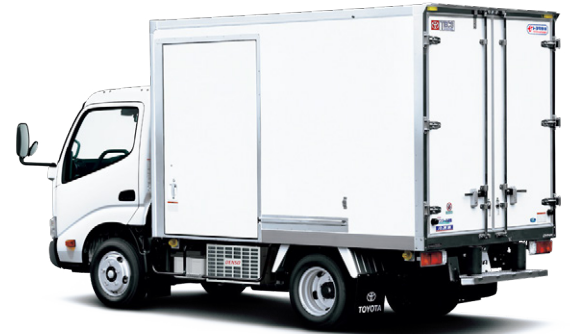
車型番号 F14 Photo:中温冷凍車 標準キャブ・標準ボディ・フルジャストロー (2KG-XZU605-VTBDZG) ※ステンレスパッケージ、ワンタッチスライド式サイドドア(ドア枠ステンレスタイプ)、サイドステップ、D型バンパーゴムは架装オプション。
