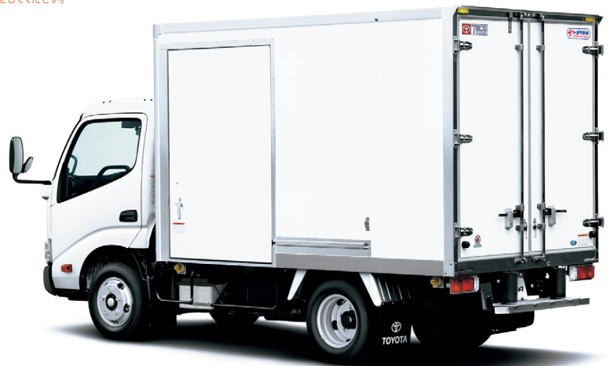
車型番号 J1 Photo:保冷車 標準キャブ・標準ボディ・フルジャストロー (2KG-XZC605-VTBBZG) ※ステンレスパッケージ、ワンタッチスライド式左サイドドア(ドア枠ステンレスタイプ)、サイドステップ、D型バンパーゴムは架装オプション。
