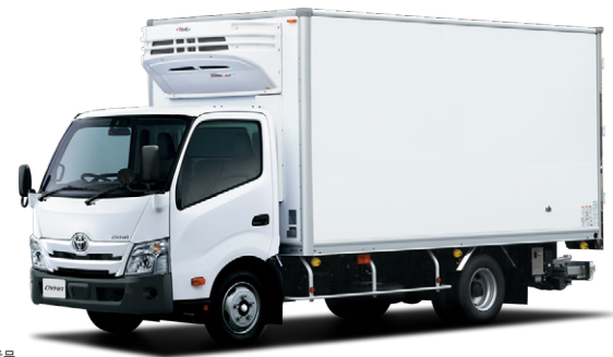
車型番号 G1 Photo:低温冷凍車 ワイドキャブ・ロングボディ・フルジャストロー (2KG-XZU710-WCBFZG) ※パッケージ型冷凍機、荷室寸法変更(長さ、高さ)、LEDサイドマーカーランプ、サイドマーカーランプ追加、サイドフラッシュャー、リヤフェンダーステンレス角型、床下収納ゲートは架装オプション。
