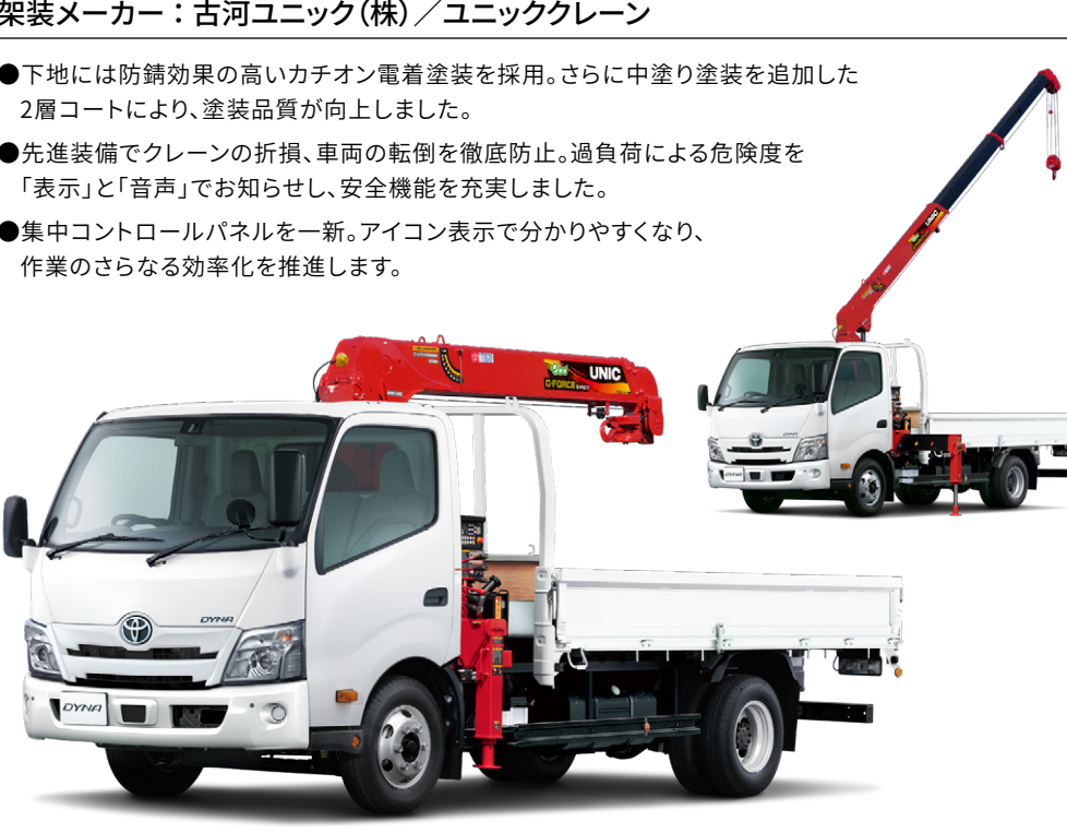
車型番号 P1 Photo:ユニッククレーン 2.9トン吊・3段ブーム・3.0トン積・ワイドキャブ・ロングデッキ・高床(2KG-XZU712-VUDSC) ※“S/パッケージ”装着車。
