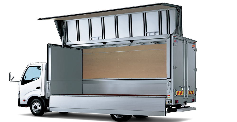
車型番号 D7 Photo:ウインググループ ワイドキャブ・超ロングボディ・フルジャストロー (2KG-XZU722-WHANXH) ※LED灯、集配型スチール製リヤステップは架装オプション。 (写真はリヤステップのオプション選択により、 大型反射板がバックドア取付に変更されています)
