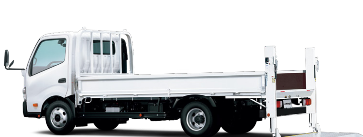
車型番号 M7 Photo:パワーリフト車 リフト能力800kg・2.0トン積・ワイドキャブ・ロングデッキ・フルジャストロー (2KG-XZU710-VTCFXG) ※ロープフックの取付位置は車型により異なります。
