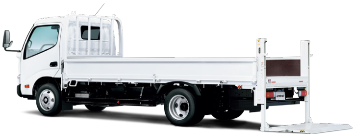
車型番号 K4 Photo:垂直式パワーゲート車 リフト能力800kg・2.0トン積・標準キャブ・ロングデッキ・フルジャストロー (2KG-XZU655-VKCFXG) ※ロープフックの取付位置は車型により異なります。
